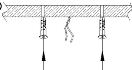
Просверлите нижнее отверстие для распорной резиновой заглушки в месте предустановочной поверхности и вставьте распорную резиновую заглушку в нижнее отверстие.
